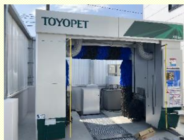
門型洗車機 近隣への騒音へ配慮し 営業時間内のみ稼働
