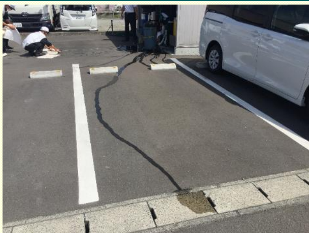
水の流れる方向を確認する 実際の液体の流れが分かった
