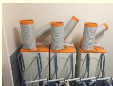
スポットクーラー フロンガス漏洩管理のため フロン簡易点検を実施
