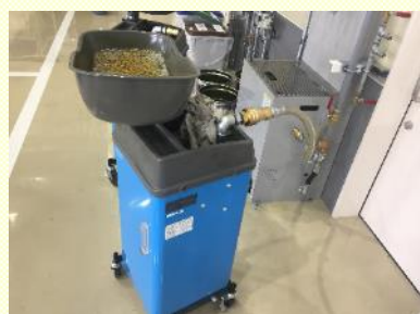
オイルドレーナー 廃油圧送ホースの状態を 点検
