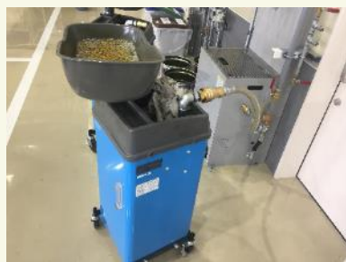
オイルドレーナー 廃油圧送ホース点検
